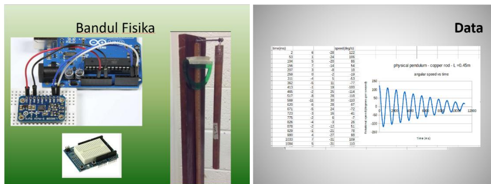
Gambar 2. Contoh bandul fisika berbasis arduino dan data yang terbaca
